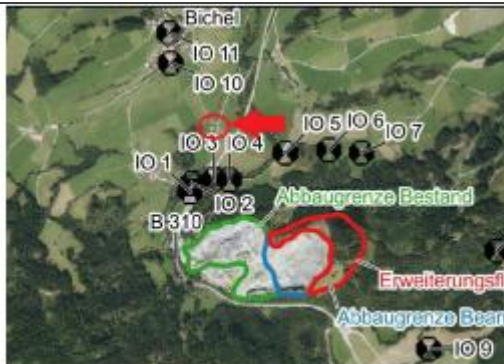
Bild 6.4 Fehlender Messpunkt (rote Markierung durch BI Steinbruch Wertach) – Quelle: Schallschutzgutachten
